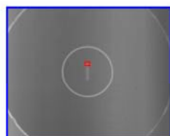
顕微鏡との視野比較 (青枠:本機 赤枠:顕微鏡)
